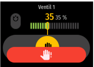
BMA0804-PO Hand-/Automatik Drehschalter in Position Handbetrieb Ventil 1 = 35%
