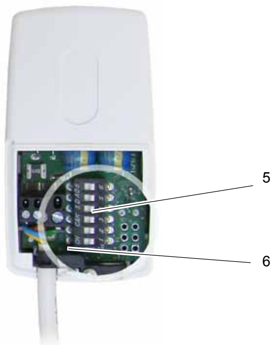
3-3: Ukazatele a ovládací prvky na servopohonu
