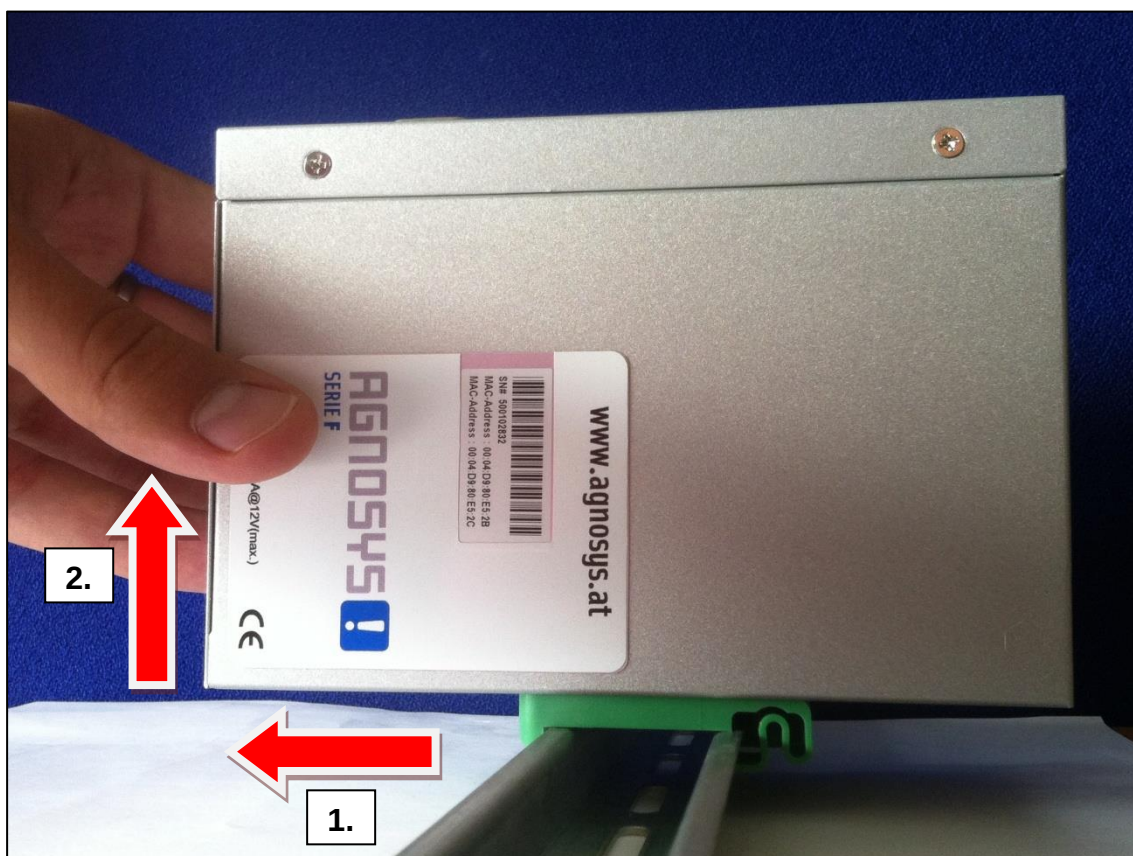
Demontage von der Hutschiene
