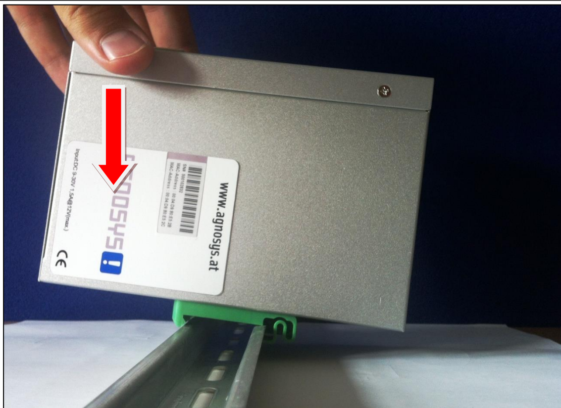
Montage auf der Hutschiene
