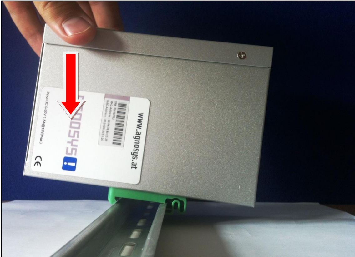
Montage auf der Hutschiene
