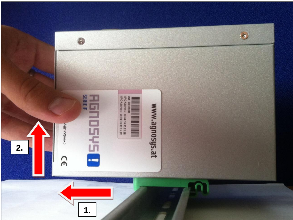
Demontage von der Hutschiene
