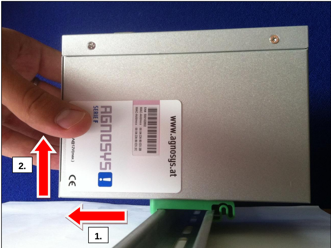
Demontage von der Hutschiene
